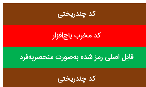
شکل ۱: ساختار یک فایل آلوده شده به VirLock
